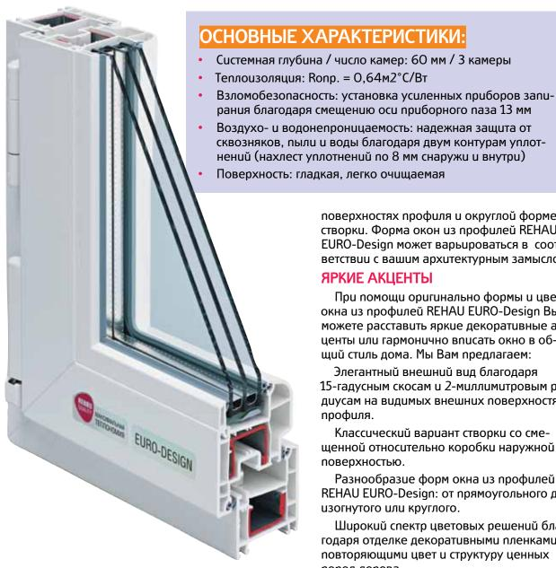
Трехкамерная система **REHAU** EURO-Design с глубиной 60 мм отвечает современным требованиям к тепло- и звукоизоляции, дизайну, надежности и долговечности. Два контура уплотнений станут надежной преградой на пути сквозняков, влаги и пыли, а гладкая поверхность профилей не обременит заказчика в повседневном уходе за окнами.
