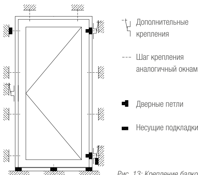
Рис. 13: Крепление балконных дверей
